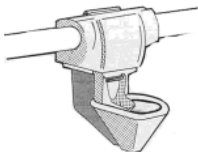
Fig. 34. Bebedero automático tipo Tazón
